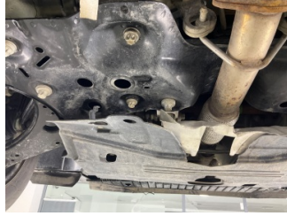
Motor, Alt muhafaza > Hasarlı
