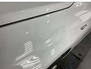
Çamurluk, sol, Çamurluk, sol > Deforme Olmuş
