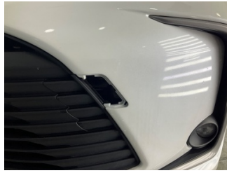
Tampon, ön, Çeki demir kapağı > Sökülmüş-Yok
