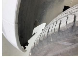
Çamurluk, sol, Davlumbaz > Hasarlı
