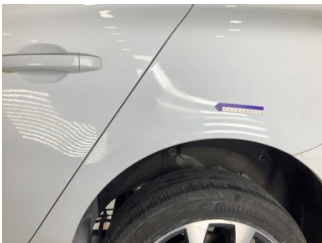
Çamurluk, sol arka, Çamurluk, sol arka > Deforme Olmuş
