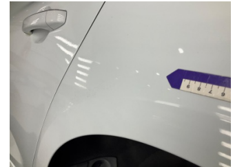
Çamurluk, sol arka, Çamurluk, sol arka > Deforme Olmuş
