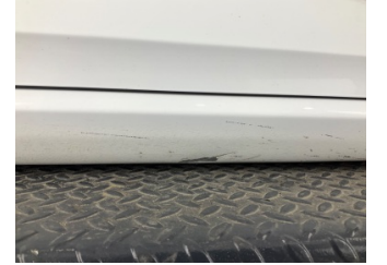
Marşbiyel, sağ, Marşbiyel, sağ > Hasarlı
