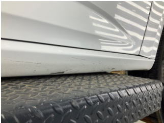
Marşbiyel, sağ, Marşbiyel, sağ > Hasarlı
