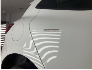
Kapı, sağ arka, Kapı, sağ arka > Ezik
