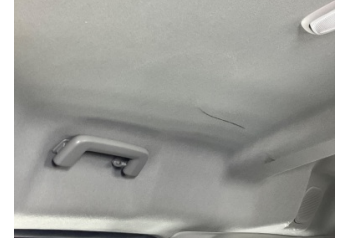
Döşemeler/Kapaklar, Tavan döşemesi > Yakıcı Madde Ile Zarar Görmüş
