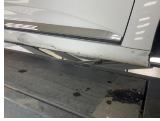
Marşbiyel, sağ, Marşbiyel, sağ > Hasarlı
