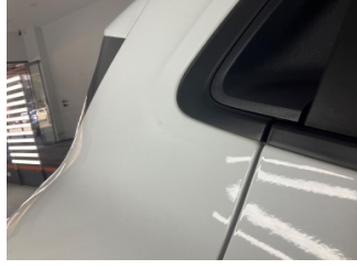
Çamurluk, sağ arka, Çamurluk, sağ arka > Ezik
