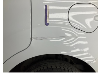
Çamurluk, sol arka, Çamurluk, sol arka > Hasarlı
