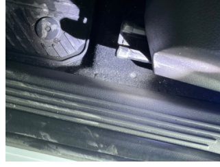
Taban, Yer döşemesi, sol ön > Yakıcı Madde ile Zarar Görmüş
