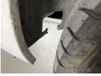
Çamurluk, sol, Davlumbaz > Hasarlı
