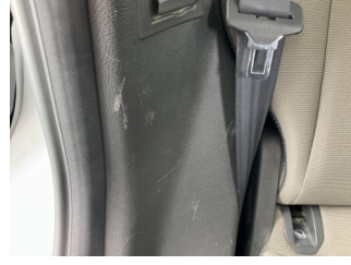
Döşemeler/Kapaklar, C-direk iç kaplaması, sağ > Çizik
