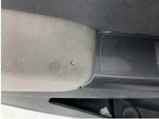
Döşemeler/Kapaklar, Kapı döşemesi, sol ön > Yakıcı Madde Ile Zarar Görmüş
