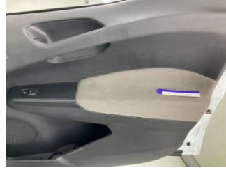
Döşemeler/Kapaklar, Kapı döşemesi, sağ ön > Yakıcı Madde Ile Zarar Görmüş
