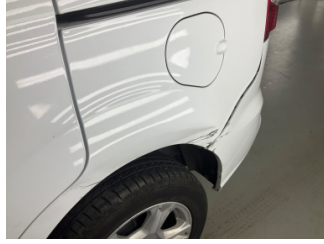
Çamurluk, sol arka, Çamurluk, sol arka > Hasarlı
