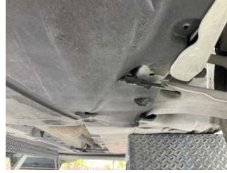
Motor, Alt muhafaza > Hasarlı
