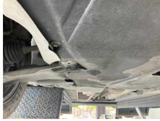
Motor, Alt muhafaza > Hasarlı
