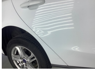
Kapı, sağ arka, Kapı, sağ arka > Ezik
