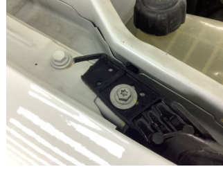
Farlar, Far bağlantı ayađı, sağ > Hasarlı
